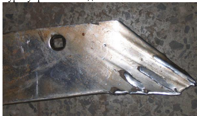
Износ наплавленного лемеха после выработки двойного ресурса относительно не наплавленного лемеха
