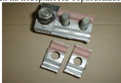
Напыление и покрытие контактных элементов электрооборудования медью и др. порошком
