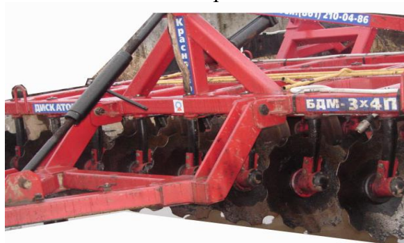
Дисковая борона упрочненная электроискровым методом
