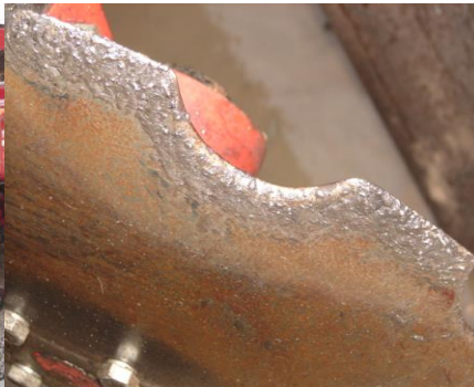
Упрочнение наружной поверхности резания
