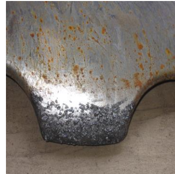
Упрочнение внутренней части зуба диска
