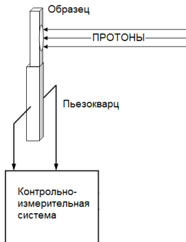
Рисунок 4. Схема измерений акустомеханических свойств образцов в процессе облучения протонами
