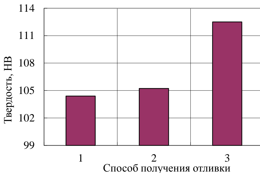
Рис. 5.2.2.7. Влияние способа получения отливки на твердость материала:
